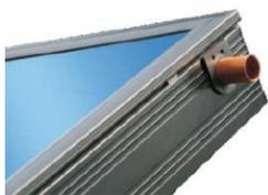
Bei der Produktion von B&S Basicx Kollektoren wird eine moderne Technologie des Biegens des Aluminiumrahmens in einem einzigen Stück eingesetzt. Ein Rahmen ohne die Lötstellen ist viel dichter, er besitzt ein ästhetischeres Aussehen und was wichtig ist, es gibt keine Gefahr, dass nach einer mehrjährigen Nutzung der Rahmen undicht wird. Der Rahmen des Kollektors ist pulverbeschichtet, um einen zusätzlichen Schutz zu gewährleisten
